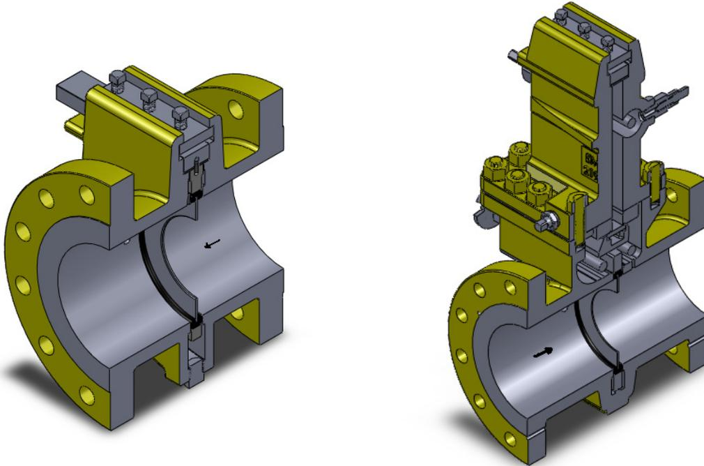
Ubicación de la placa orificio en Armadura porta placa monocámara y bicamara
