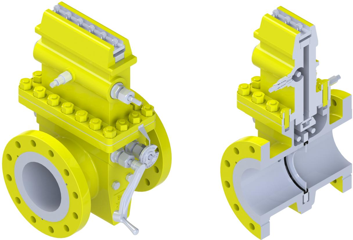
Este Porta Placa permite mediante un método extremadamente simple y rápido el cambio de la placa orificio bajo presión sin interrumpir la circulación del fluido, ya que ha sido diseñada con doble recámara. De esta manera se eliminan los costos de by-passes, válvulas y otros accesorios indispensables en una instalación convencional con bridas orificios, porta placas Monocámaras, etc.
