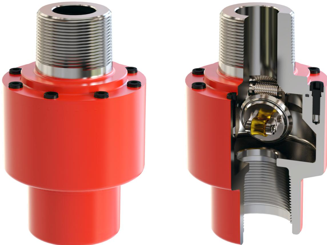
La válvula de prevención de rotura de vástago puede ir montada entre el B.O.P Ratigan y el Tee prensa. Cuenta con un sistema de cierre a clapeta accionado por resorte, que no daña el vástago y actúa en el caso de corte de vástago cerrando el pozo y evitando cualquier tipo de derrame.
