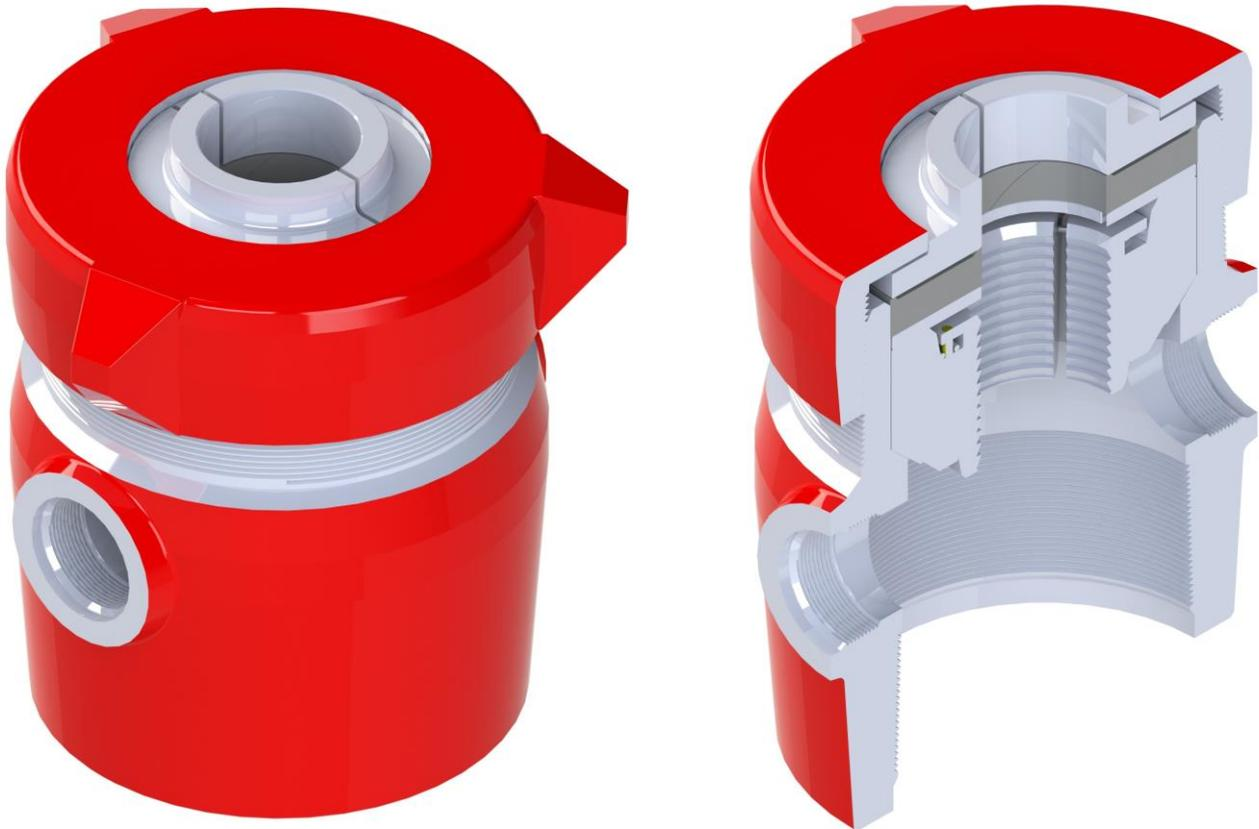
Las cabezas colgadoras para tubería de producción, están desarrolladas para colgar tuberías en yacimientos con presiones hasta 2000 psi de forma eficaz y económica, construidas de acuerdo a Norma API Spec 11 IW.
